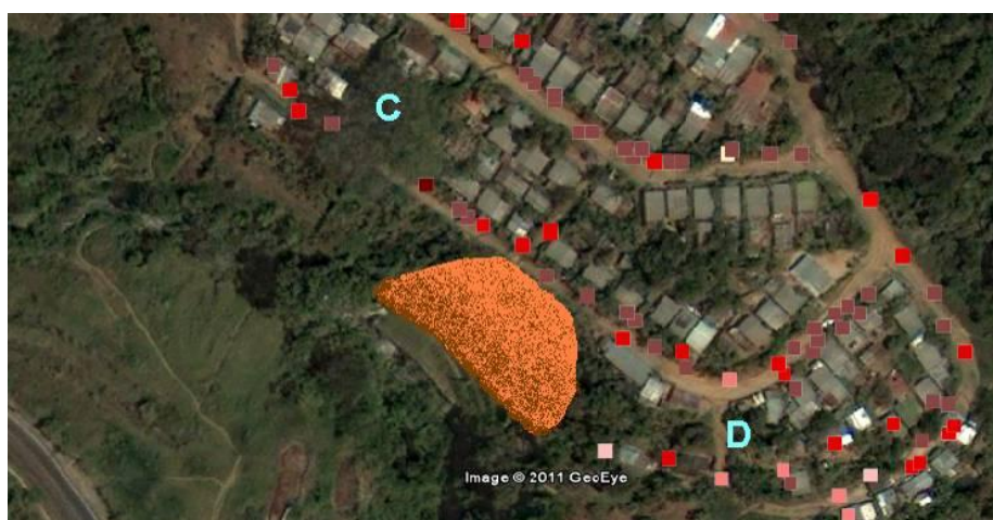
Figura 12 Talud inestable (color naranja) en Colonia El Triunfo, lugar donde ya ocurrió deslizamiento.
